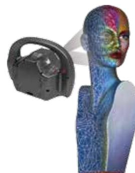
Il suo utilizzo è simile a quello di una video camera, l'operatore impugna il sensore e lo sposta inquadrando l'oggetto. Il modello 3D acquisito viene visualizzato in tempo reale sul monitor mentre la scansione viene completata.
